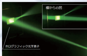
ホログラムプリンタで作成したホログラフィック光学素子
